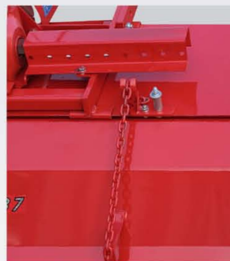
Zadnjom kukom sa lancem podešava se ravnanje kultivisanog zemljišta i štiti se bacanje grudvi The rear hood is used to level the tilled soil and to avoid throwing of clods
