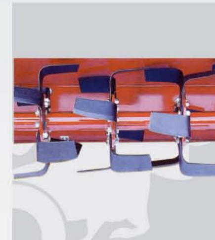
Specijalni oblik motičica je raspoređen po spirali rotora i omogućuje lako razbijanje grudvi i usitnjavanje zemlje The special shape of the tools (blades) fixed to the sustaining flanges in a helicoidal phase, can easily crush the clods and the pulverise the soil
