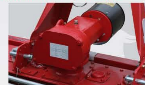
Reduktor rotacione drljače / Low-range gear lever (gear drive) Opcija: višestepeni reduktor sa dva izlazna vratila za pogon agregatiranih mašina Option: multi speed gearbox with two exit shaft for optional additional machines
