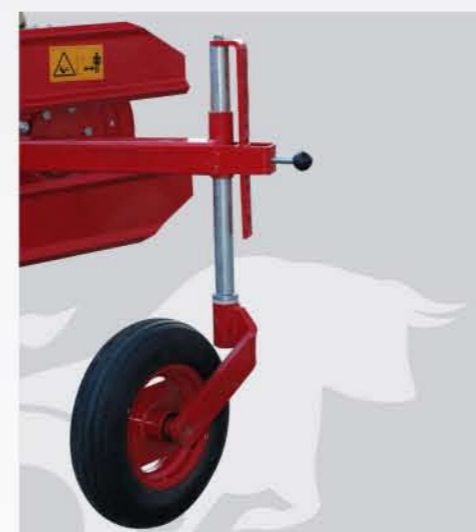
Povlačenjem poluge (ručice) prevrtač - sakupljač postavlja se u željeni položaj za rad By pulling the handle the machine will be put lower to the desired position to work
