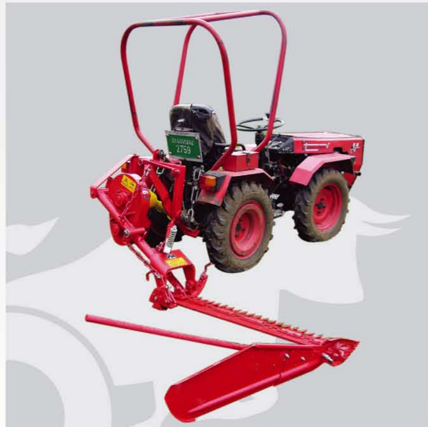
Kosačica sa jednom reznom letvom i duplim prstima Mower with single cutter bar and double - finger
