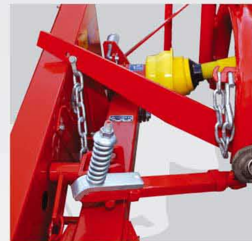
Podešavajući sigurnosni mehanizam štiti kosačicu u slučaju nailaska na skrivenu prepreku Adjustable tension breakaway safety release protect the mower
