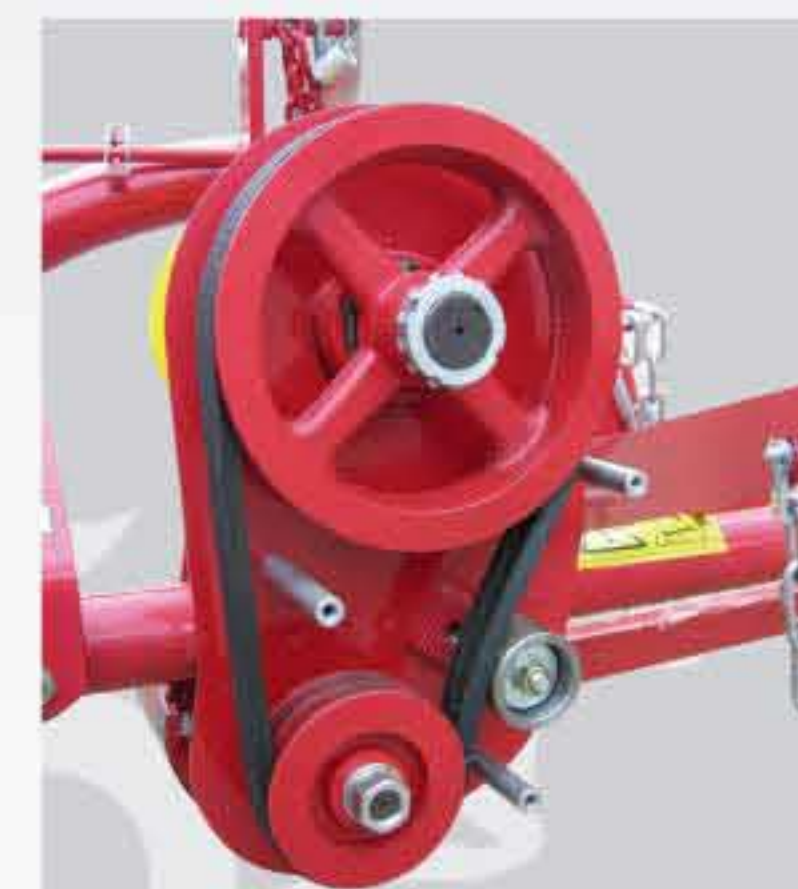
Pogon sa klinastim kaiševima i zatezačem Adjustable V-belt drive
