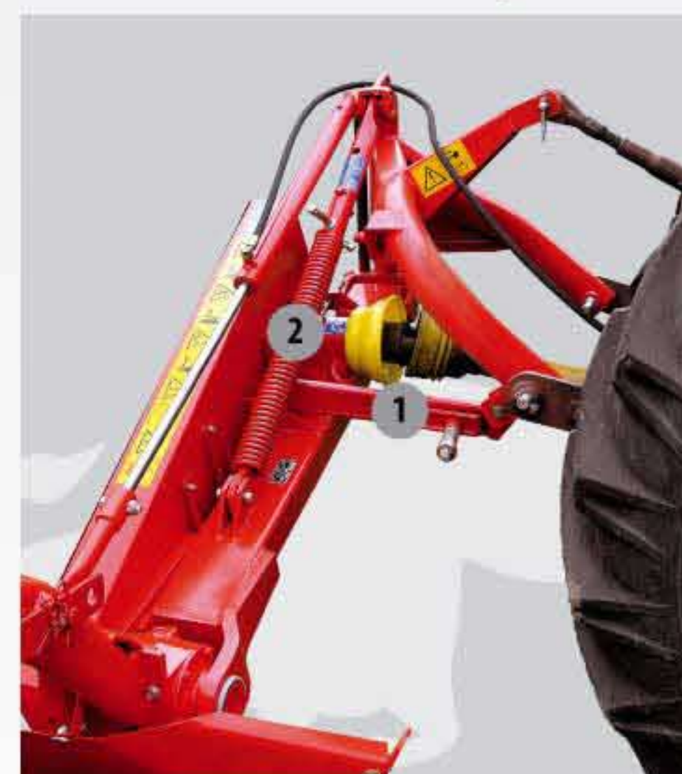
1. Balansna letva za automatsko otključavanje reznog aparata. 2. Plivajuća poluga za podešavanje pritiska na površinu. 1. Safety release device is for unlocking the cutter bar. 2. The floating system is for adjusting the pressure to the surface.
